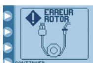
Problème provenant du rotor et du silicone enroulé sur le rotor. S'assurer que le silicone est correctement mis en place sur le rotor.
