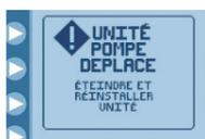
La bague noire (MISTIC) n'est pas correctement mise en place dans son logement. S'assurer que la tubulure est correctement chargée.
