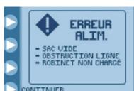
La poche de nutriment est vide ou présence d'une obstruction sur la ligne en amont de la pompe, valve mal positionnée. Vérifier si la tubulure n'est pas coudée ou bloquée jusqu'à la pompe ou changer la poche de nutriment ou, bien enclencher la valve.
