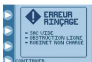
Le conteneur d'eau est vide ou il y a une obstruction sur la ligne en amont de la pompe. Vérifier si la tubulure n'est pas coudée ou bloquée jusqu'à la pompe ou remplir à nouveau la poche à eau.
