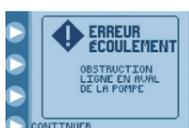
Obstruction sur la ligne aval de la pompe. Vérifier si la tubulure n'est pas coudée ou bloquée jusqu'au malade et rectifier.
