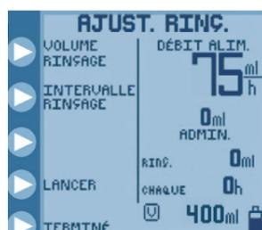
7. Appuyer sur VOLUME de RINÇAGE pour programmer le volume de rinçage/ hydratation. Appuyer sur INTERVALLE de RINÇAGE pour programmer l'intervalle entre chaque rinçage/hydratation.
