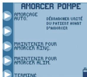
1. Appuyer sur AMORCER puis sur Amorçage automatique pour purger automatiquement ou TENIR appuyé le bouton de purge manuelle pour purger la tubulure. Appuyer sur TERMINÉ quand la tubulure est purgée.
