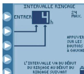
9. Appuyer sur les boutons de gauche pour programmer l'intervalle entre chaque rinçage/ hydratation. Appuyer sur TERMINÉ pour revenir à l'écran principal.
