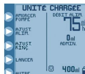
6. Appuyer sur AJUSTER RINÇAGE pour programmer le volume et l'intervalle de rinçage/hydratation.
