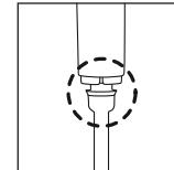
La partie en forme de cloche sous la poignée doit être entièrement visible pour être certain que la sonde est entièrement déployée et prête à l'emploi.
